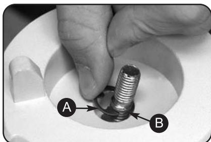
Теперь проденьте резьбовой штифт снизу вверх через основание треноги и вдвиньте С-образный зажим (А) в углубление (В) резьбового штифта.
