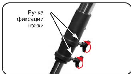
Ослабив ручки фиксации треноги, отрегулируйте ее высоту. Вытяните выдвижную внутреннюю часть каждой ножки на нужную длину, затем затяните ручки фиксации. Высота треноги должна обеспечивать удобство наблюдения.
