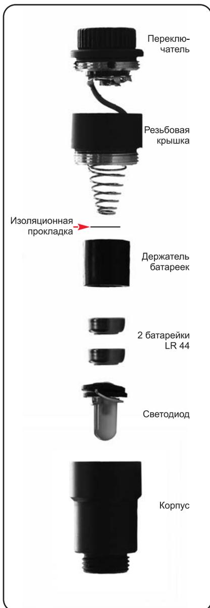
Светодиодная визирная сетка полярного выравнивания работает от двух батареек для часов. Изначально между этими батарейками проложена пластиковая пленка, предохраняющая их от разрядки. Помните: если светодиодная визирная сетка не используется, подсветку надо выключить.
