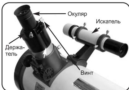
Прикрепите кронштейн искателя. Снимите гайки с винтов кронштейна искателя. Проденьте винты в отверстия кронштейна искателя. Поставьте гайки на место и затяните без усилия. Установите трубу искателя. Открутите коллимационные винты искателя и вдвиньте трубу искателя в кронштейн. Затяните коллимационные винты без усилия.
