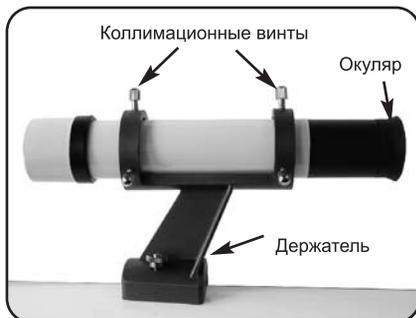
Глядя в искатель, ослабляйте или затягивайте (как нужно) один или несколько коллимационных винтов искателя до тех пор пока прицел не будет точно центрирован на объекте, который вы предварительно центрировали в окуляре телескопа. Теперь телескоп готов к проведению наблюдений.
