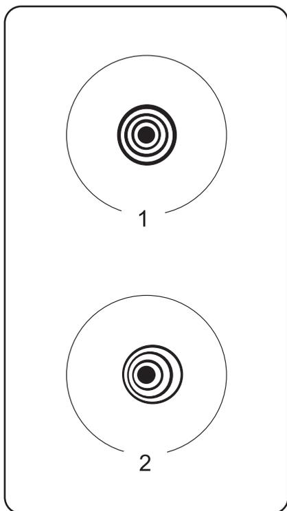
Если отражение в диагональном зеркале не центрировано с отражением в первичном зеркале, отрегулируйте 3 винта на задней поверхности корпуса первичного зеркала.
