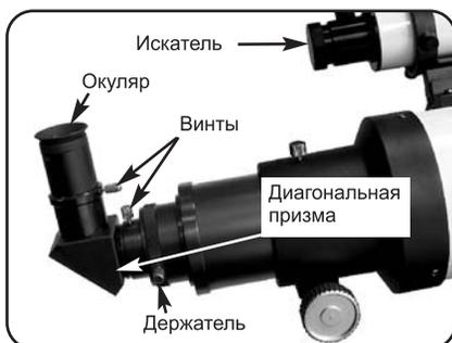
Вставьте окуляр. Снимите пылезащитную крышку с держателя окуляра на модуле фокусировщика. Уберите пылезащитную крышку в футляр и наденьте ее обратно после окончания работы. Вдвиньте диагональную призму в держатель и затяните винты без усилия (только для ахроматических рефлекторов). Открутите винты окуляра и вставьте поставляемый в комплекте 25-мм окуляр в держатель окуляра. Затяните винты держателя без усилия, чтобы закрепить окуляр на месте.
